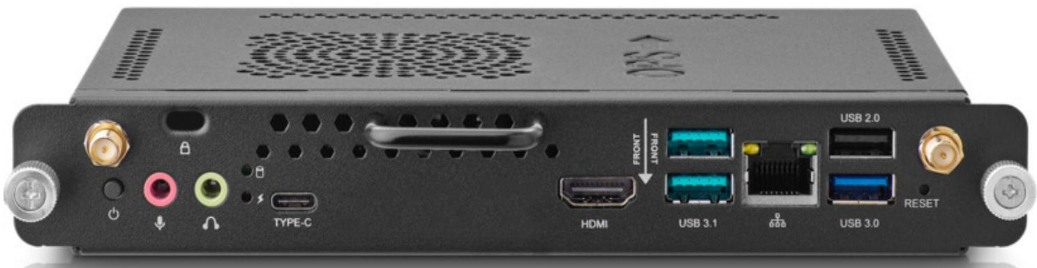
همچنین دارای دو پورت USB 2.0 و USB 3.0، یک پورت IN HDMI، ورودی میکروفون و خروجی صدا است. برای اتصال بی‌سیم به شبکه یک پورت RG-54 و برای اتصال به اینترنت به صورت سیمی و کابل نیز از یک جفت آنتن وای فای بربخوردار می‌باشد.
